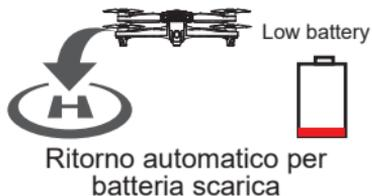
Quando il livello della batteria è basso, il drone tornerà automaticamente alla posizione di decollo. Durante il ritorno è possibile usare i joysticks per controllare la quota e la direzione del drone in modo da evitare eventuali ostacoli.
