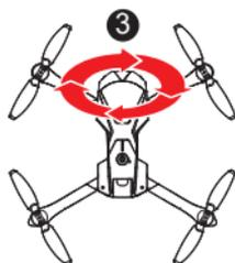
Tenere il drone in verticale e ruotare 360 gradi per un po'. L'indicatore lampeggerà velocemente fino a diventare fisso.
