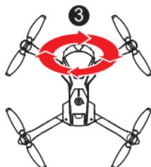
Tenez le drone verticalement et faites-le tourner à 360 degrés pendant quelques instants. L'indicateur clignote de rapidement à constant.
