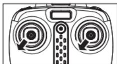
Lorsque le drone rencontre un impact direct avec des objets étrangers en mode sans tête (headless), en cas de déviation de la direction définie, il suffit de pousser simultanément les manettes gauche et droite vers les coins inférieurs gauche après avoir placé la direction de vol du drone en position de correction. Lorsque le voyant lumineux LED du drone est en mode «ON» après avoir clignoté lentement pendant 3 secondes, il indique que l'étalonnage est terminé.
