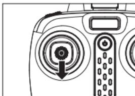
**Méthode 1:** Poussez le joystick gauche (accélérateur) au niveau le plus bas et maintenez-le enfoncé pendant 2 à 3 secondes, le drone peut alors être éteint.
