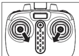
**Méthode 2:** Poussez les joysticks gauche et droit vers les coins intérieurs inférieurs pendant 1 seconde, les lames du drone commencent à tourner lentement.
