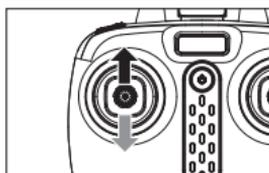
Etape 4: Poussez le joystick gauche (accélérateur) jusqu'au point le plus élevé, puis tirez vers le bas jusqu'au point le plus bas. Lorsque les voyants du drone passent du clignotement rapide à l'éclairage continu, cela signifie que le drone passe en mode veille de vol.
