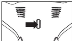
1. Drücken Sie den Netzschalter oben auf der Drohne, um sicherzustellen, dass die Drohne ausgeschaltet ist.
