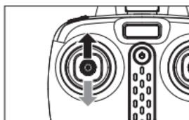
Schritt 4: Drücken Sie den linken Joystick (Gas) bis zum höchsten Punkt und ziehen Sie ihn dann bis zum niedrigsten Punkt nach unten. Wenn die Anzeigelampen in der Drohne von schnellem Blinken zu Dauerlicht wechseln, wechselt die Drohne in den Flugbereitschaftsmodus.
