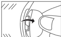
2. Drücken Sie auf die Batterieabdeckung, öffnen Sie sie und entfernen Sie die Batterie.
