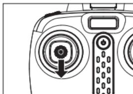
**Methode 1:** Drücken Sie den linken Joystick (Gas) auf die niedrigste Stufe und halten Sie ihn 2 bis 3 Sekunden lang gedrückt. Die Drohne kann dann ausgeschaltet werden.
