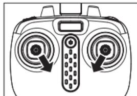
**Methode 2:** Schieben Sie den linken und rechten Joystick 1 Sekunde lang in die unteren inneren Ecken. Die Klappen der Drohne beginnen sich langsam zu drehen.
