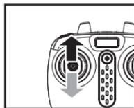
Schritt 3: Bewegen Sie den linken Steuerknüppel ganz nach oben und danach ganz nach unten. Die Drohnenanzeige leuchtet auf. Schalten Sie fest (leuchten), um anzuzeigen, dass die Drohne flugbereit ist.
