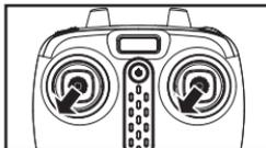
Im kopflosen Modus kann die Vorwärtsrichtung sein beginnen aufgrund zahlreicher Abstürze abzuweichen. Zurücksetzen die Vorwärtsrichtung und nach dem Drücken beider Stöcke gleichzeitig in die untersten linken Ecken. Die Drohnenanzeigelampen beginnen zu blinken und leuchten nach 3 Sekunden dauerhaft (leuchten), um eine erfolgreiche Kalibrierung anzuzeigen.
