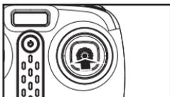
Beobachten Sie nach erfolgreichem Pairing die Drohne-anzeigelampen und warten Sie, bis sie dauerhaft leuchten (leuchten). Drücken Sie den rechten Stick und halten Sie ihn 2 Sekunden lang gedrückt. Der Sender gibt 3 Pieptöne aus, um anzuzeigen, dass der Headless-Modus aktiviert ist. Drücken Sie den rechten Stick erneut und halten Sie ihn 2 Sekunden lang gedrückt, nachdem der Sender einen langen Piepton ausgegeben hat, der anzeigt, dass der Headless-Modus deaktiviert ist.
