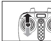
3. Bewegen Sie den linken Steuerknüppel ganz nach oben und danach ganz nach unten. Der Sender gibt einen langen Piepton aus, der die erfolgreiche Kopplung und die definierte Vorwärtsrichtung anzeigt.
