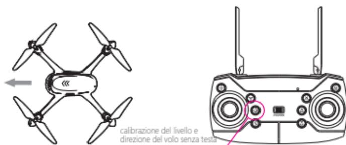
Quando il drone è nei seguenti stati, è possibile utilizzare la modalità di volo senza testa,
